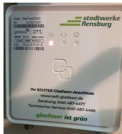
Wie man auf dem Foto vielleicht erkennen kann, leuchtet da eine LED leider noch rot. Grund dafür ist, dass die Leitung vom Clubheim zum Verteilerkasten jetzt zwar steht, dass jedoch laut Aussage der Techniker jetzt die Stadtwerke an diesem Verteiler noch etwas einrichten müssen, damit der Anschluss dann endlich aktiviert werden kann.
